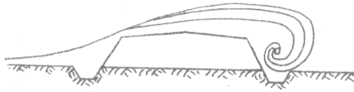
Рис.3.22. Обтікання поперечного профілю дороги з насипом і крутими схилами
